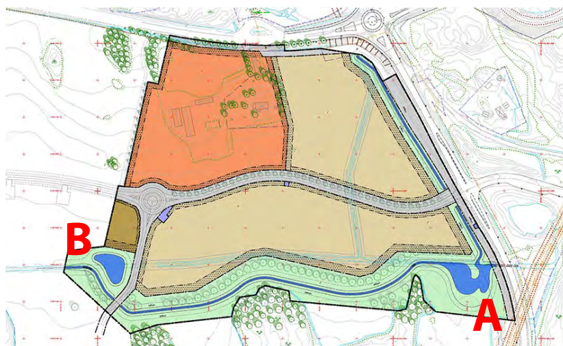
Figur 13. Förslag till omplacering av diket samt förslag till placering av fördröjningsdammar. A –fördröjning av bakgrundsvatten, B - fördröjning av dagvatten
