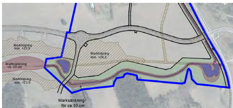
Figur 21. Koncept för justering av marknivåer innanför och utanför planområdet för att skapa förutsättningar för skyfallshantering
