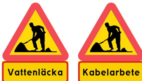
Illustration 8 Exempel på skyltning vid akuta arbeten och kortare VA-arbeten (exempel på text i tilläggstavla)
