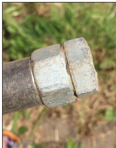
Figur 4. Bult som ersatte spetsen på stålörret i provpunkt SW17_PG4.
