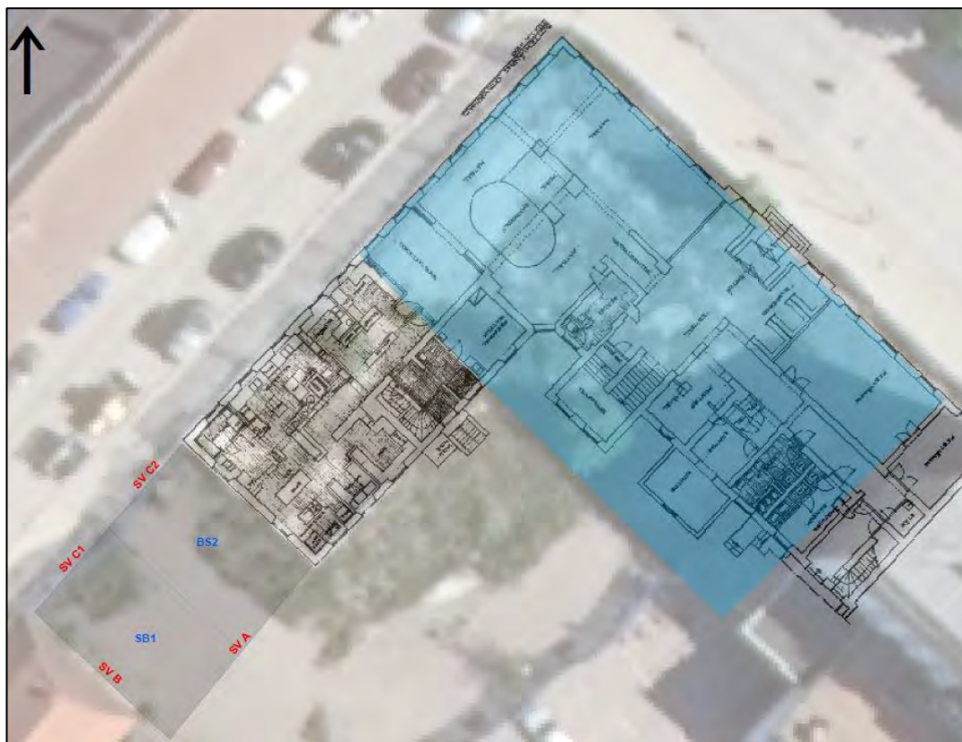
Figur 5. Planritning av stadshotellet från 1965 och flygfoto. Gråa ytor = slutschaktat, blå text hänvisar till schaktbottenprov och röd text till schaktväggsprov. Blå yta har delvis schaktats under 2017 men arkeologiska undersökningar kvarstår inom detta område. Kartan återfinns även i bilaga 1B .
